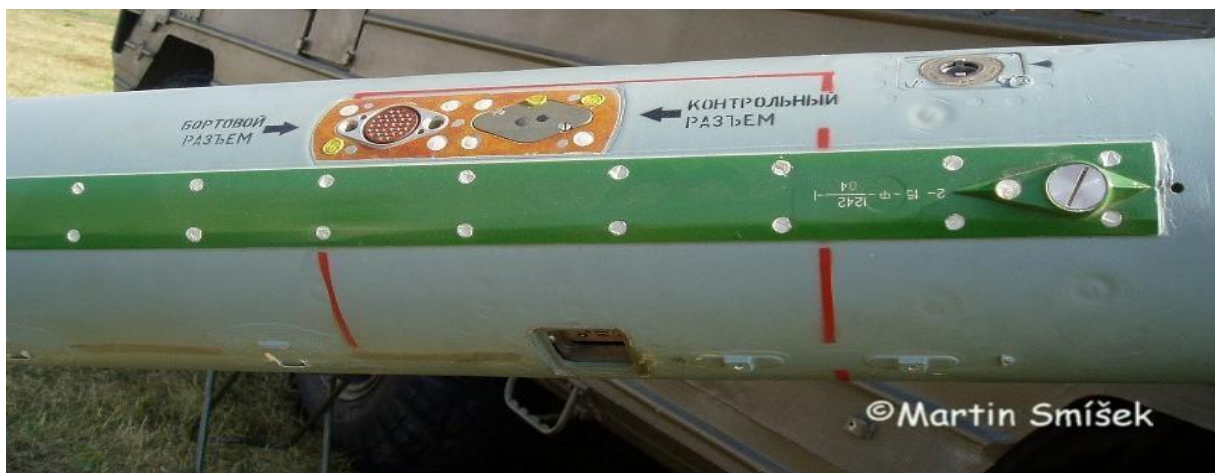
Abb. 3 Mittelteil der Rakete mit Bord- und Kontrollstecker
