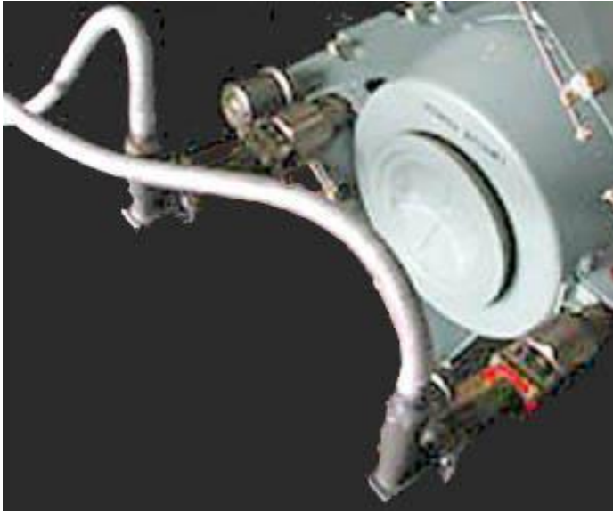
Abb.4 Heckteil der Rakete mit Sende- und Empfangsantennen
