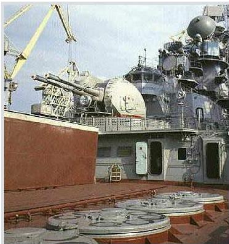
УВП ЗУР 9М330 и антенный пост системы управления ЗРК "Кинжал" в кормовой части атомного крейсера "Петр Великий"
